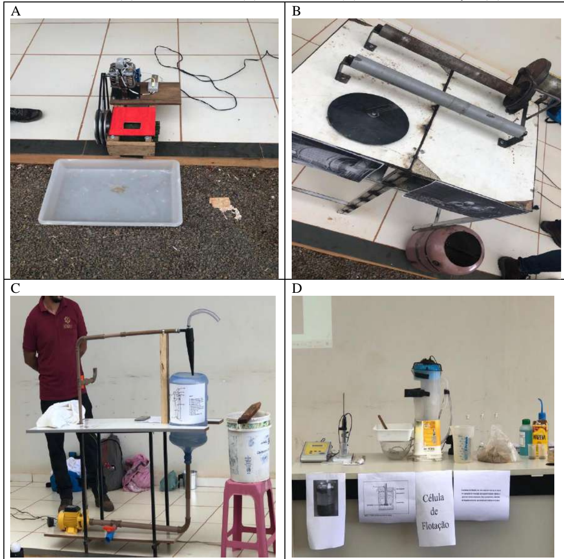
Figura 7 - Protótipos construídos pelos discentes da Engenharia de Minas da UFVJM. Britador de rolos (A), Moinho de bolas (B), Hidrociclone (C) e Célula de Flotação (D).
