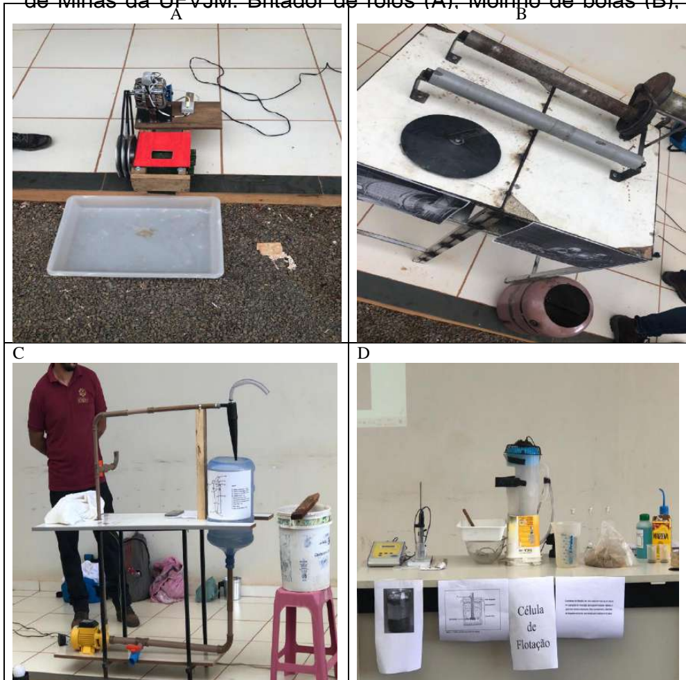
Figura 7 - Protótipos construídos pelos discentes da Engenharia de Minas da UFVJM. Britador de rolos (A), Moimho de bolas (B),
