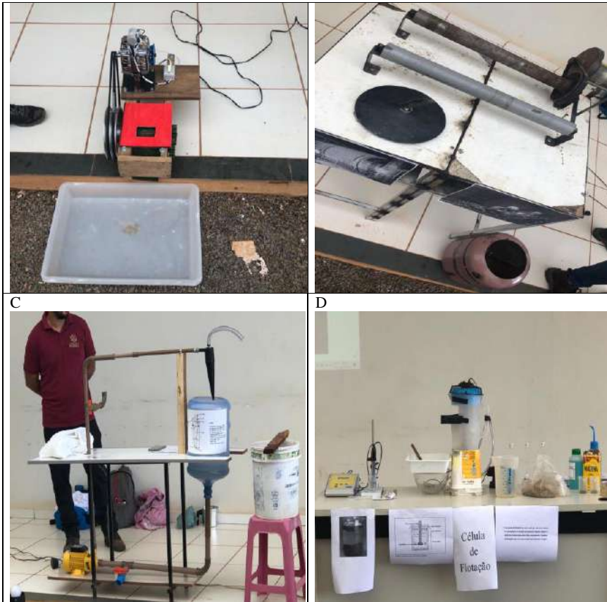
Figura 2 - Protótipos construídos pelos discentes da Engenharia de Minas da UFVJM. Britador de rolos (A), Moinho de bolas (B), Hidrociclone (C) e Célula de Flotação (D).
